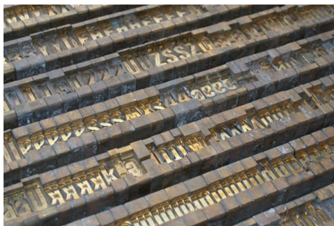
Obr. 10. Sady matic na výrobu liter k odlévacímu stroji Ludlow Typograph.
