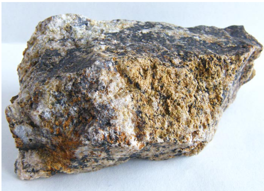
Obr. 1 Malayait s scheelitem v prokřemeněném skarnu z Horního Nezdína, velikost vzorku 10 x 5 cm, foto S. Kopecký.
