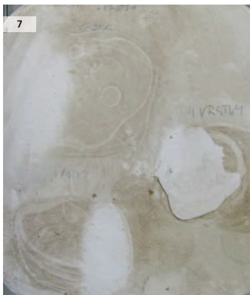
Obr. 7: Očištěné vrstvy nařaděné želatiny (světlejší části).
