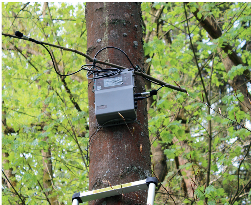
Obr. 1. Instalace SM3Bat detektoru se zajištěním proti snadnému odcizení. Fig. 1. Installation of a SM3Bat detector with protection against easy theft.
