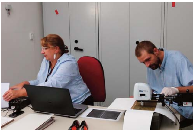
Obr. 1. Radka Šefců a Karel Křenek při průzkumu dvoulistu Rukopisu zelenohorského Ramanovou spektroskopií pomocí mobilního Ramanova spektrometru s vláknovou optikou iRaman Plus od firmy BWTek. Foto: Eliška Peterková.
