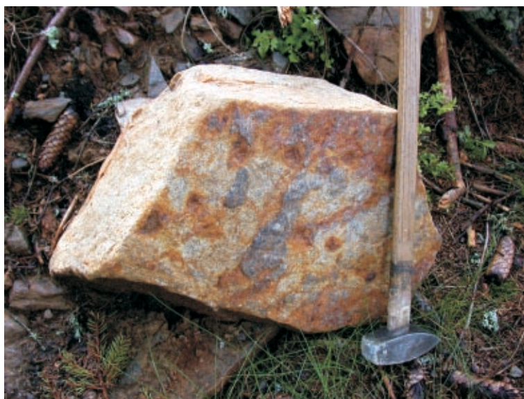
Obr. 8 Žilný granit s turmalínem rozlomený přímo po žíle s šedým křemenem a zvětřelými zrny arsenopyritu rezavohnědé barvy, kóta Břemeno. Foto B. Šreinová, červen 2008.
