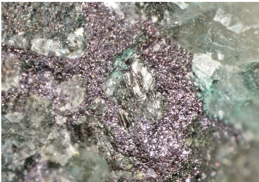
Obr. 1 Kulovité agregáty uraninitu místy s bílými inkluzemi clausthalitu obrůstáný umangitem (růžově fialové anizotropní agregáty), Zálesí; šířka obrázku 700 \mu\text{m} , foto v odraženém světle (částečně zkřížené nikoly) J. Sejkora.
