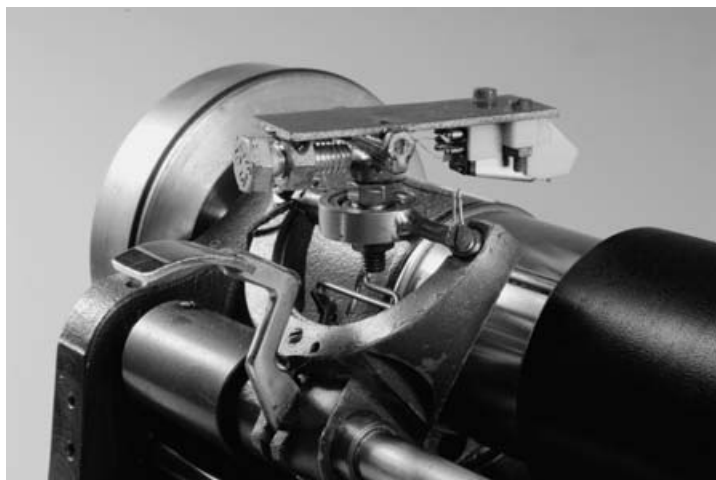
Přehrávač, detail setrvačnicku a přenosky / Player, detail of the balance wheel and pickup
