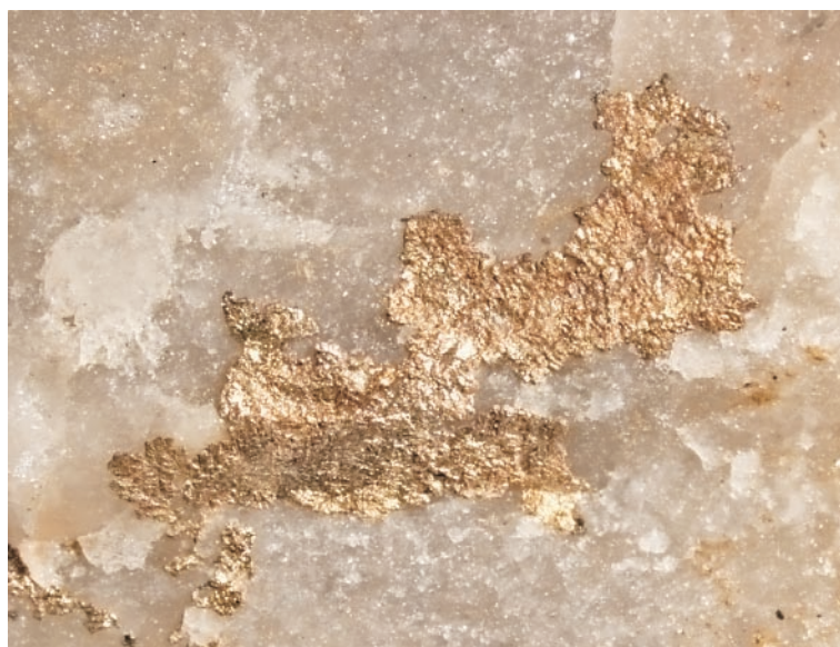
Obr. 5 Plíškovité ryzí stříbro na trhlině křemenné žiloviny. Foto J. Sejkora, šířka obrázku 7 mm.
