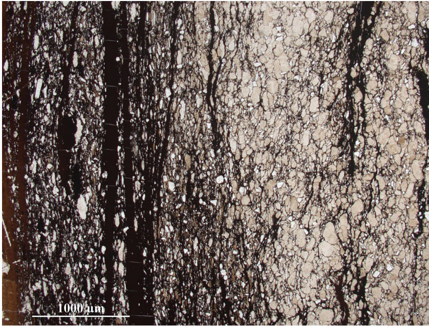
Obr. 6 Svrchní část tonsteinové polohy s patrným přibýváním laminární uhlé hmoty směrem do nadloží (doleva). Foto Š. Beliš, 2015.
