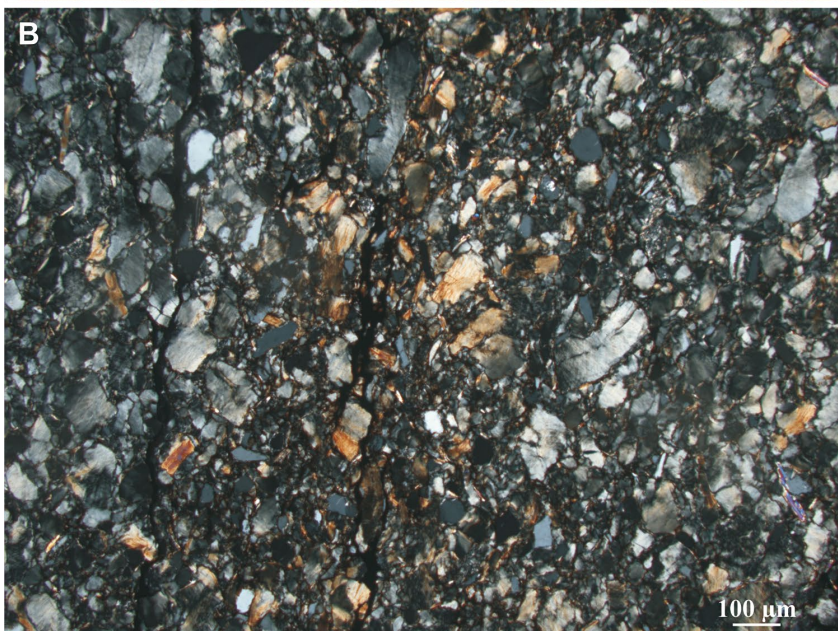
Obr. 7 Výbrus tonsteinu v procházejícím světle. a - jeden nikol, b - zkřížené nikoly. Patrná je převaha izometrických zrn kaolinitu a také střípkovitá zrna křemene. Foto Š. Beliš, 2015.
