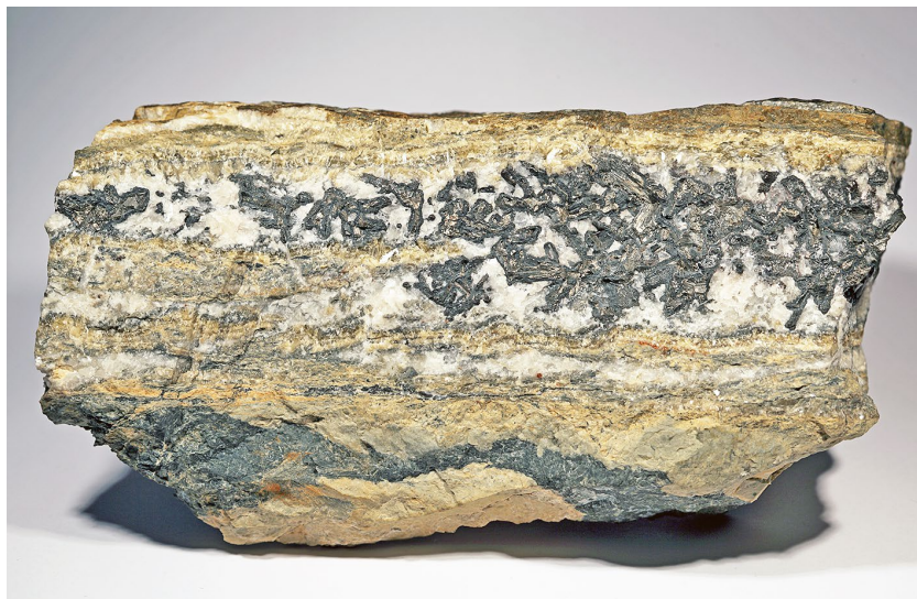
Obr. 5 Žíla H14F3 z okolí 7. patra š.č. 21. Žíla o mocnosti 6 cm je makroskopicky tvořena hojným dyskrazitem s lemy arsenu a kalcitem. Foto P. Škácha.
