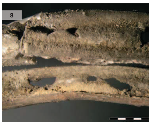
Obr. 8: Detail proděravěného jádra olověného H-profilu.
