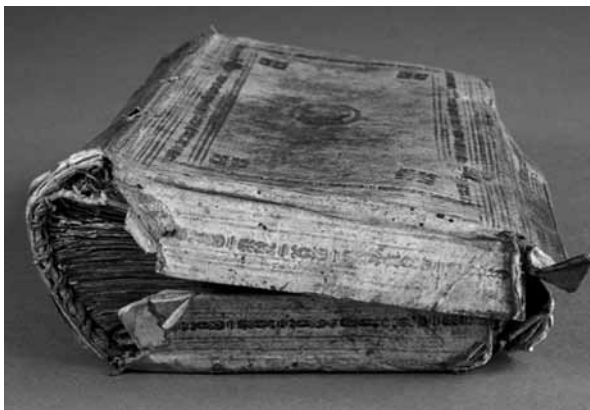
Obrázek 8: Vyřezané listy z měšťanského památníku Jana Aleše zv. Kompas sign. XVII F 60 způsobily poškození knižní vazby s ochrannými hranovými přehyby (foto Archiv OR)
