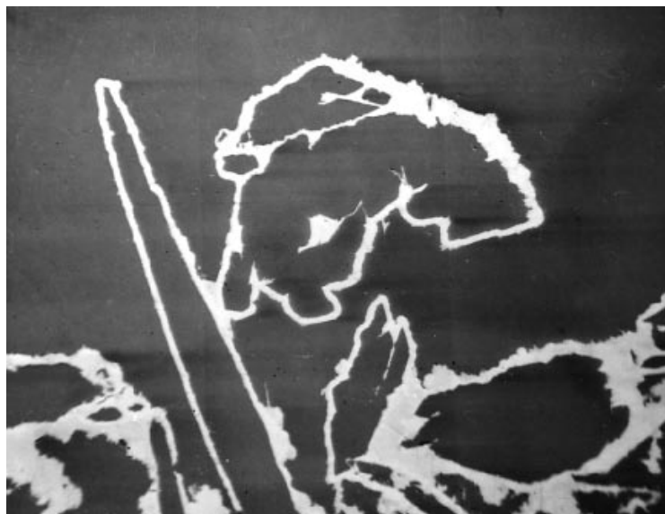
Obr. 26 Ztlačování předrudního kalcitu uraninitem (světle šedý) podél hranic kalcitových zrn. Šachta č. 82 Nahošín, zóna Na-2-jih, odžilek v rozrážce V 2 -9, nábrus, obraz v sekundárních elektronech, delší strana obrázku 7 mm. Foto V. Cílek.
