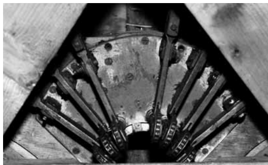
Pohled do vnitřní části podstavce, uchycení sedmi pedálů a výřez pro osmý pedál / View of the interior of the base, attachment of seven pedals and cutout for the eighth pedal
