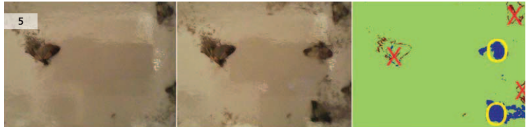
Obr. 5: Série snímků zachycených senzorem polétavého hmyzu s grafickým výstupem obrazové analýzy (identifikace nově zachycených jedinců).
