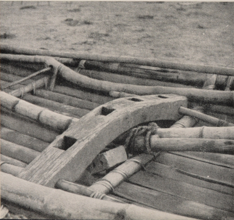
Öffnungen zur Befestigung des Mastbaumes
