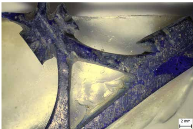
Obr. 5. Stopy po použití nástroje s kulatým zakončením, Stero-OM.
