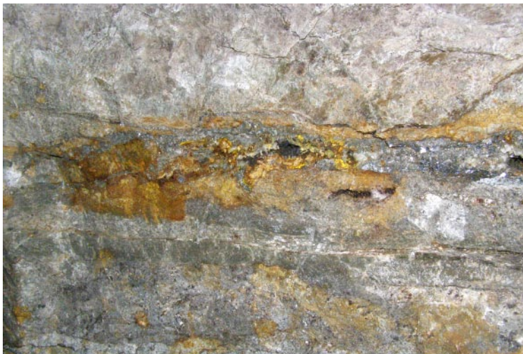
Obr. 3 Detail na výskyt supergéennej uránovej mineralizácie v strope chodby razenej po polymetalickej žile s primárnou uránovou mineralizáciou. Šírka záberu je 50 cm, foto M. Števko, 2011.
