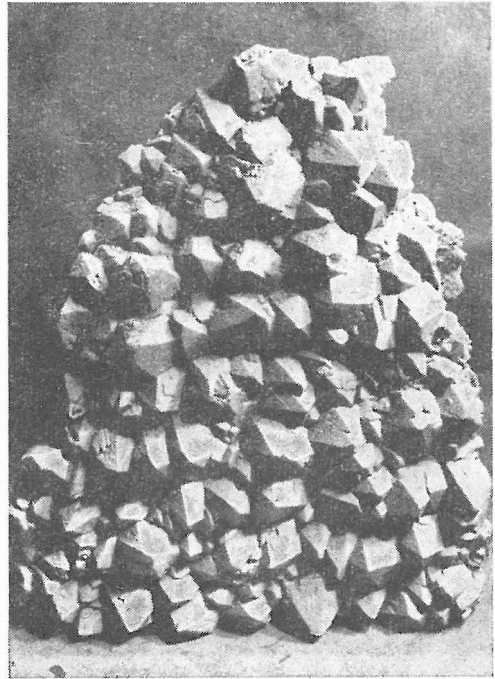
Obr. 6. Drúza krystalů křemene z dutiny žíly „Bochovice“. Skutečná velikost 30×25 cm.
