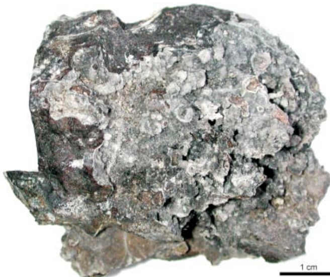
Obr. 6 Vzorek melilititu ze Želének (Litologie 2, vzorek Ze5). Hornina obsahuje vedle melilitu hojný \text{CaSiO}_4 , magnezioferit a akcesorické ferity barya a vápníku. Foto V. Žáček.
