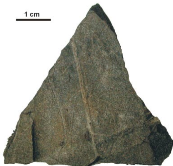
Obr. 34 Vzorek „magnetické břidlice“ z dolu Bílina (B1). Vysoký obsah sideritu a deskovitý tvar ukazují, že protolitem byl tenký proplástek bohatý sideritem. Foto V. Žáček.
