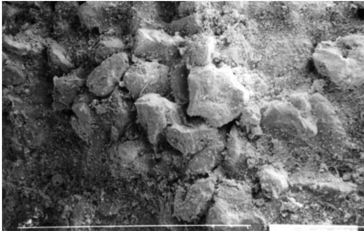
Obr. 2. Ploché tabulkovité krystaly sádrovce, vzorek pískovce č. 1. Mikroskop JEOL JSMT 200. Delší rozměr obrázku 1.4 mm.
