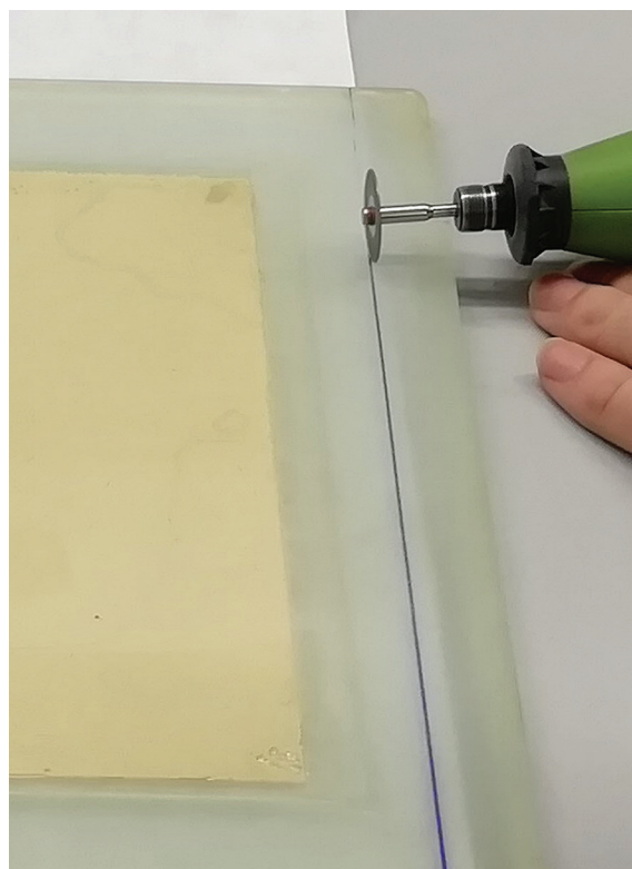
Obrázek 7 – Řezání skleněné desky sendviče elektrickou přímou bruskou (foto VŠCHT Praha)
