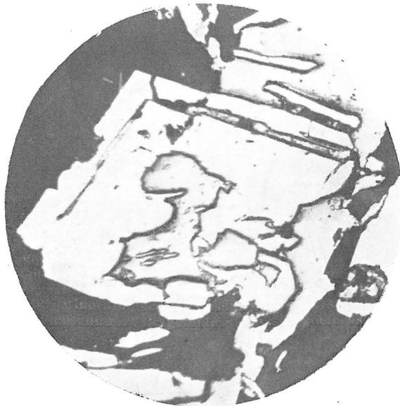
Abb. 7. Arsenopyrit (weiss) wird von Kobellit (weissgrau) selektiv verdrängt. Siderit ist dunkelgrau. Anschliff, ohne Nicols, Vergr. 130 mal. Krištof II — Stollen, Halde.
