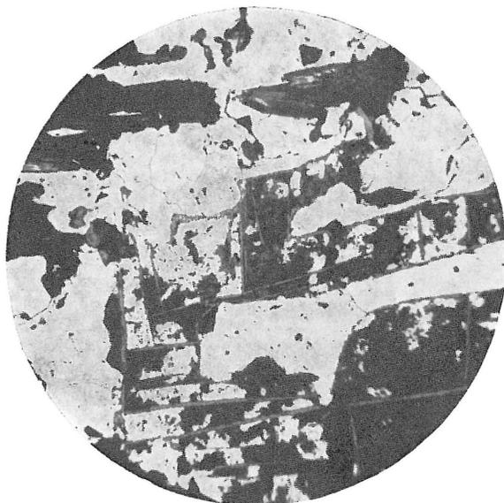
Abb. 4: Das Durchdringen von Sulfiden (einschliesslich des Polydymits) in den Titanomagnetit-Kristall mit der Ilmenitkruste Anschliff, ohne Niclos, Vergr. 70 mal. Kunratice.
