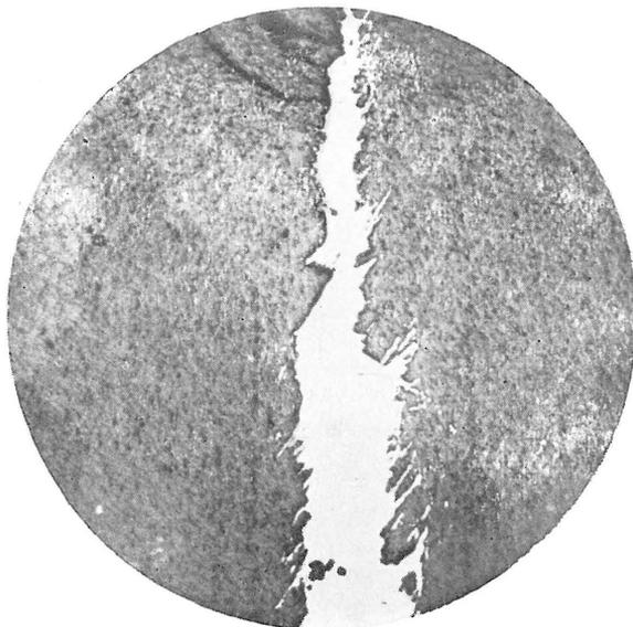
Abb. 3. Kobellitgängchen im Siderit. Anschliff, ohne Nicols, Vergr. 20 mal. Raky-Stollen Ausrichtungsstrecke gegen West.
