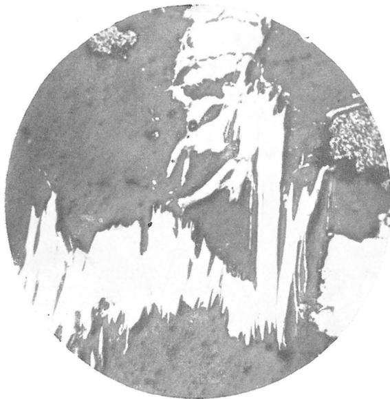
Abb. 2. Stengelige bis nadelige Aggregate von Kobellit (weiss) im Siderit (dunkelgrau). Die Körner mit der rauhen Oberfläche gehören zum Pyrit. Anschliff, ohne Nicols, Vergr. 60 mal. Krištof III — Stollen, Halde.
