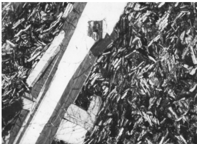
Obr. 4 Mikrofoto vulkanitu z vrtu Ch-3a s vyrostlicí lištovitěho labradoritu. Zkrřížené nikoly. Spodní strana obrázku 0.46 cm. Foto J. Šindelářová.
