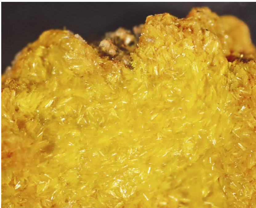
Obr. 1 Jasně žluté krystalické agregáty složené z jehlicovitých krystalů uranopilitu a jáchymovitu. Horní Slavkov. Šířka obrázku 4 mm. Mikrofoto J. Sejkora.
