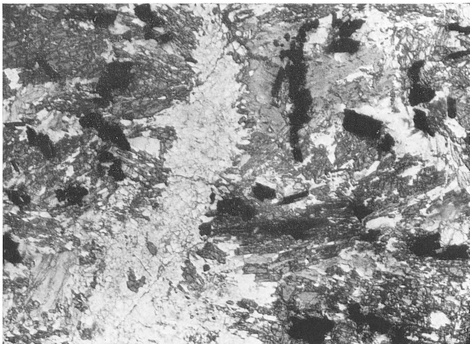
Amfibolitový kakirit z Chocopy. Zona intenzivní mylonitizace podél trhliny protíná jen slabě mechanicky postiženou horninu. // nikoly, zvětšeno asi 30 ×.
