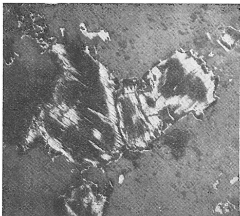
Jemně vláknitý agregát směsi pyritu + markazitu, vznikající rozkladem pyrhotinu. // nikoly, zvětšeno asi 40×. (Foto 9)
