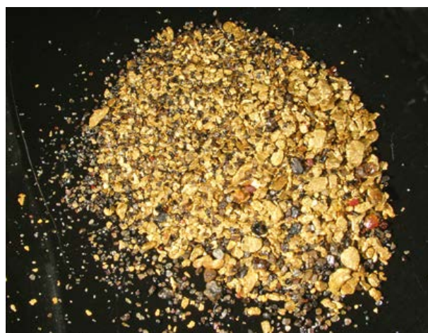
Obr. 9 Zlato vyrýžované z rozsypu bezejmenného potůčku jv. od Klínce pod Pinkausy (M. Šimon), hmotnost koncentrátu 0.613 g. Foto J. Sejkora, šířka obrázku 1.9 cm.
