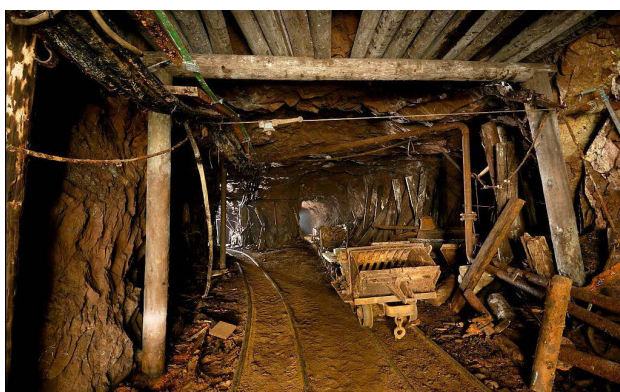
Obr. 62 Výstroj chodby na dole Skalka. Archivní foto, M. Korba.
