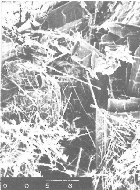
Fig. 1. Pb-Sulfoantimonat (III) Wolfsberg, Inventarnummer 9626. Sekundärelektronen (1000-fach vergrössert).
