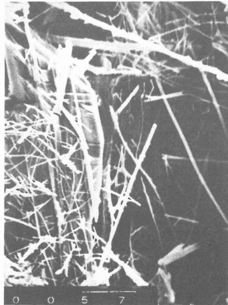
Fig. 2. Pb-sulfoantimonat (III) Wolfsberg, Sekundärelektronen (3000-fach vergrössert)
