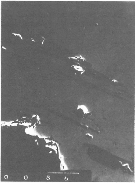
Fig. 3. Anschlifffläche von Pb-Sulfoantimonat (III), aufgenommen in COMPO (300-fache Vergrößerung)
