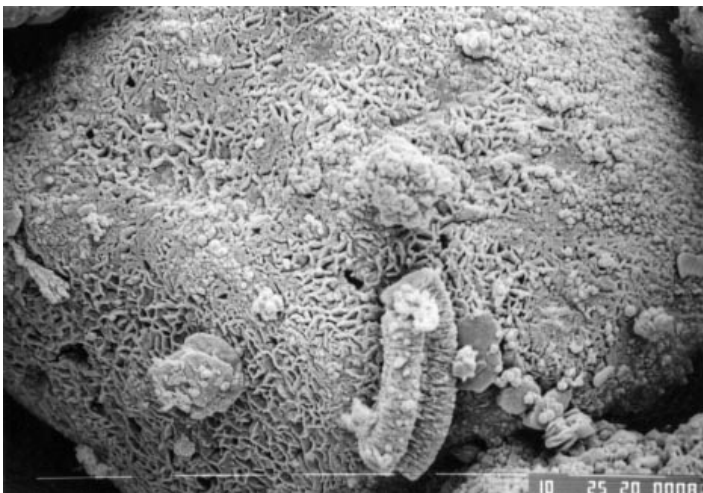
Obr. 3 „Květákový“ povrch zrna glaukonitu s vermikulárním agregátem kaolinitu, rastrovací mikroskop JEOL JSM 200. Délka obrázku je 0.11 mm. Foto J. Šrámek a J. Kulich.
