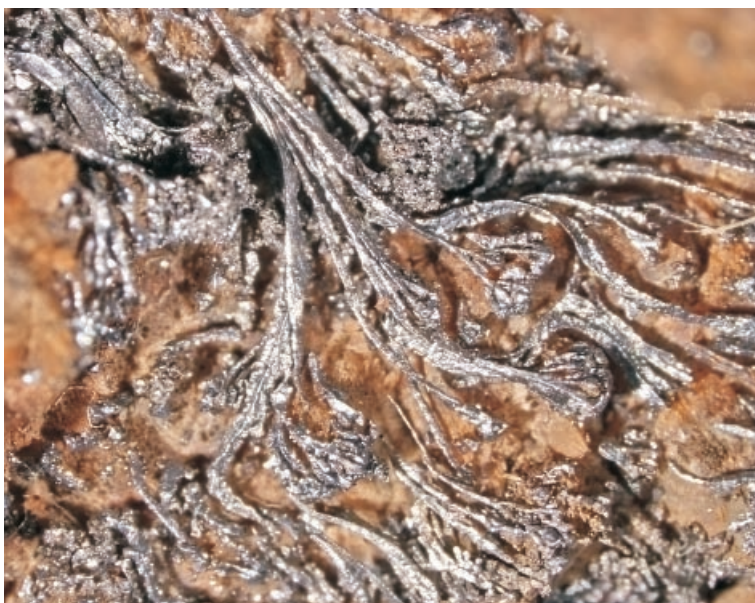
Obr. 2 Ploše větvičkovité agregáty galenitu na kalcitu. Foto J. Sejkora, šířka obrázku 9 mm.
